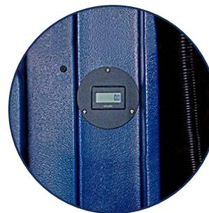
Le compteur d'autonomie indique combien heures pendant lesquelles la machine a fonctionné.
